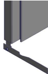
Transportschiene bei gepulverten Zargen
