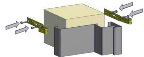
4. Die Zarge (1) mit erdfeuchtem Standardmörtel (ca. 1:4, nach DIN 1053-1) hinterfüllen. Nach dem Trocknen der Hinterfüllung die Ausspreizung entfernen. Anschließend kann die Wand verputzt werden.
