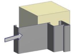
2. Leibungszarge Planar (1) lot- und waagrecht ausrichten und fixieren. Beim Fixieren darauf achten, dass die Zarge einen gleichmäßigen Abstand zur Wand hat.
