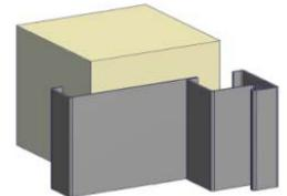
3. Die leicht nach innen gewölbte Zarge so ausspreizen, dass die Falzmaßbreite (FMB) auf der gesamten Höhe eingehalten wird. Die Nagelanker (4) in die Zarge einhaken und mittels Schrauben (5) mit dem Mauerwerk verbinden.
