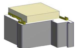
5. Elastik-Hohlkammerdichtung (6) erst nach dem Trocknen der Zargenlackierung einsetzen. Bei der Montage des Bandes die Hinweise auf der Dichtungsverpackung beachten.
