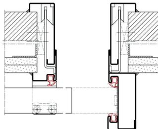
LineaOutside-D ist eine Schiebetürzarge für vor der Wand laufende Schiebetüren. Diese dichtschießende Version ist mit einer 4-seitig umlaufenden Dichtung ausgestattet.
